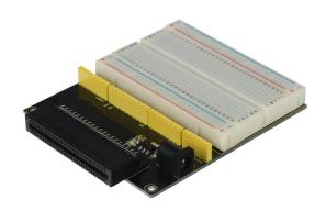
Dieses Breakoutboard macht alle Kontakte des Micro:Bit als Pinbuchse einfach zugänglich. Zusätzlich verfügt es über eine geregelte Spannungsversorgung, die es ermöglicht das Breakoutboard mit 5-9V zu betreiben.
